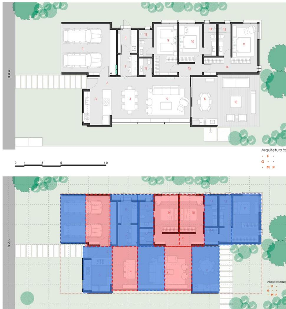
Acima, na planta baixa, em azul estão representados os módulos 3D e em vermelho, os cômodos em que serão usados módulos 2D, nos painéis de piso, de vedação interna, de vedação externa e de cobertura. Na Fig. 11 destacam-se detalhes do projeto desenvolvido em BIM.
